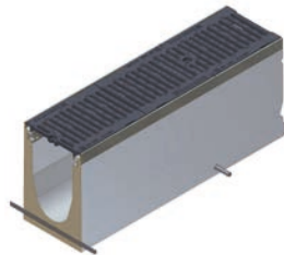
Sistema di ancoraggio, tubi nella base della canaletta (2 pezzi per metro)
