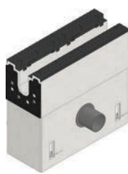
Pozzetto di scarico, 2 elementi, con scarico in PE-HD e cestello zincato (per canale con guarnizione)
